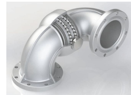
Шарнир серии 0878: алюминиевый двурядный, состоит из 2-х частей с поворотными коленями и фланцами тип TTMA.
