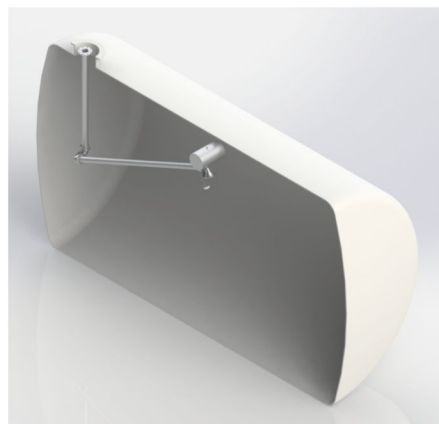
Горизонтальная секция ПУВ с колоколом, следует за изменением уровня жидкости, всасывая только чистый слой
