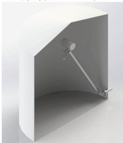
Горизонтальная секция ПУВ с колоколом, следует за изменением уровня жидкости, всасывая только чистый слой
