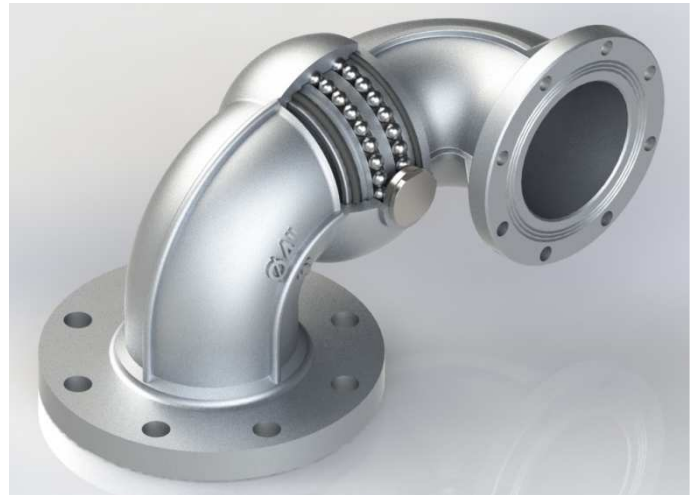
Шарнир серии 0878: алюминиевый двурядный, состоит из 2-х частей с поворотными коленами и фланцами тип ТТМА от 80 мм до 150 мм и тип PN10 от 200 мм до 600 мм.
