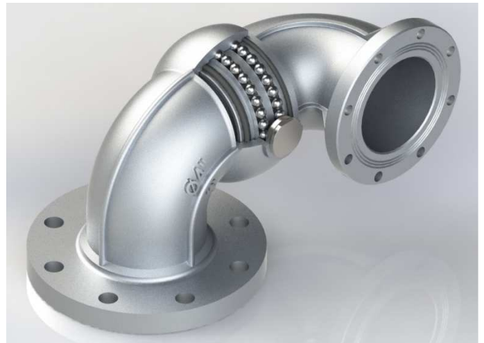
Шарнир серии 0878: алюминиевый двурядный, состоит из 2-х частей с поворотными коленями и фланцами тип ТТМА от 80 мм до 150 мм и тип PN10 от 200 мм до 600 мм.
