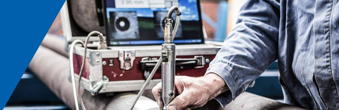
Система электромагнитно-ультразвукового контроля коррозии «КА-СКОР» предназначена для контроля состояния трубопроводов, изготовленных из стали или других сплошных однородных металлов, на предмет проходящих в них коррозионных и эрозионных процессов в режиме реального времени.
