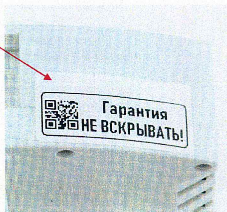
Рисунок 5 – Схема нанесения пломбы изготовителя
