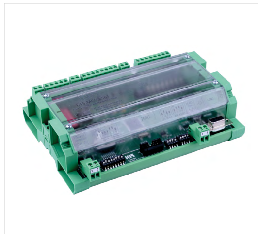
Внешний вид контроллера «K15.MCU.2561»
